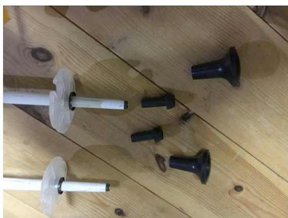
ストックを改造してできたポールと使用したゴムの先端
